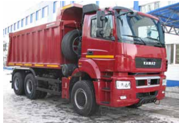
Оптимизированная геометрия нового самосвального кузова НЕФАЗ позволила наилучшим образом перераспределить нагрузку между передней осью и задними мостами и избежать перегрузов
