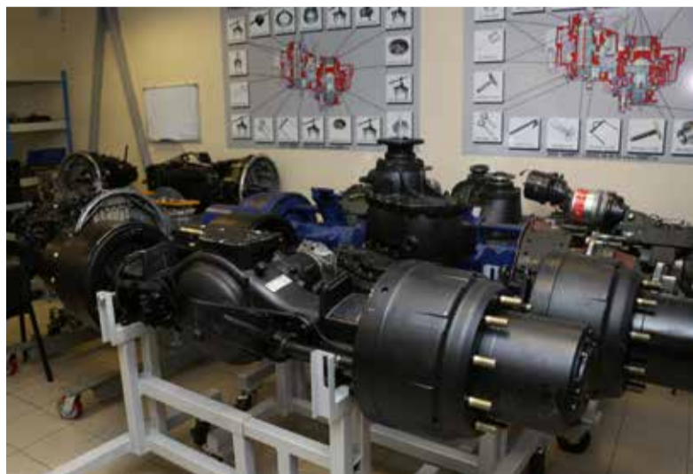
Визуальные отличительные особенности оригинальных мостов — литая некрашенная колодка тормоза, наличие тормозной камеры, качество покраски главной передачи, а также отсутствие вмятин и заусениц на ней, некрашенная шпилька колеса
