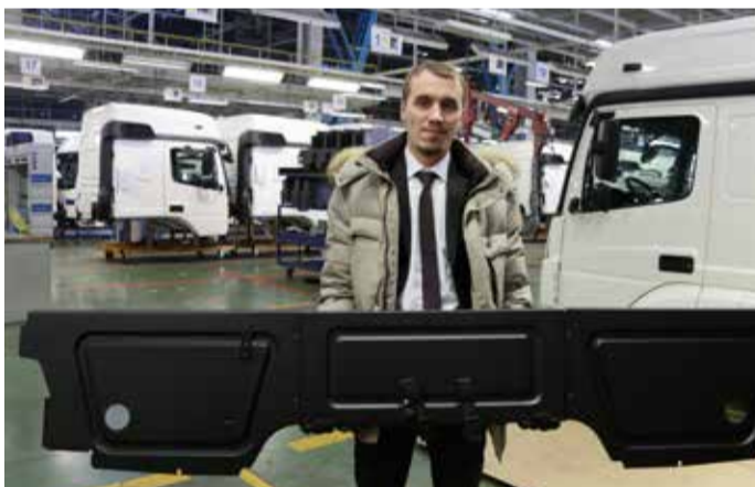
Сергей Мандрик показывает рундук из штампованной стали. Этот элемент, на который устанавливается матрас, станет следующим шагом в процессе локализации спального места
