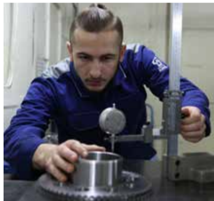
Иван производит замеры опытного образца шестерни
