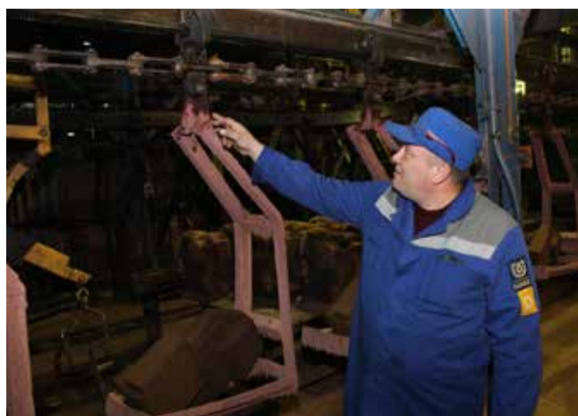
Начальник цеха капитального ремонта Сергей Коваленко показывает каретки, на которых перемещаются отливки
